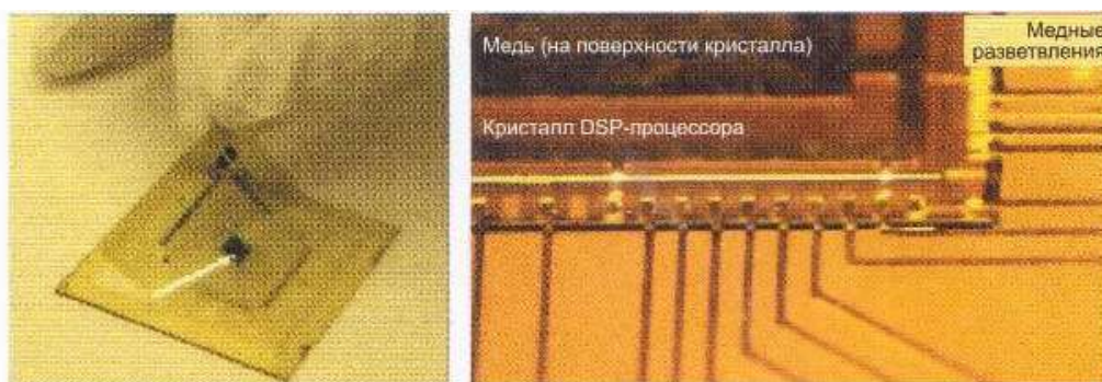
Рис. 2. Общий вид устройства, выполненного по технологии UTCР
