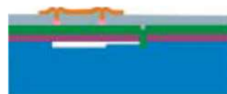
Рис. 6. Структура ЧЭ абсолютного давления
